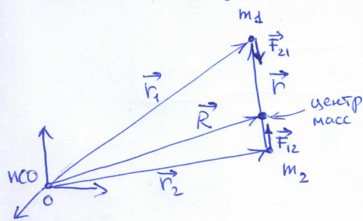
Уравнение Ньютона для этой системы имеет вид (см. Рис.):
