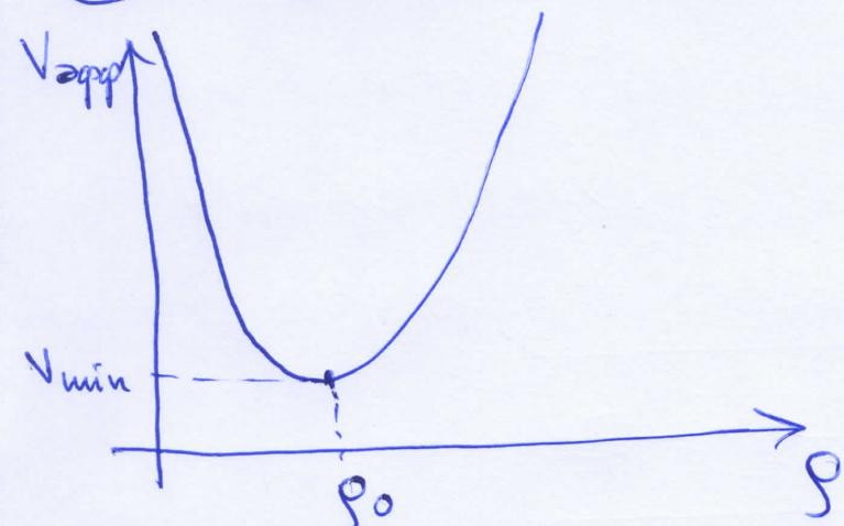
В таком мире есть одна устойчивая круговая орбита  $r = r_0$ ,  $E = V_{\min}$ .
