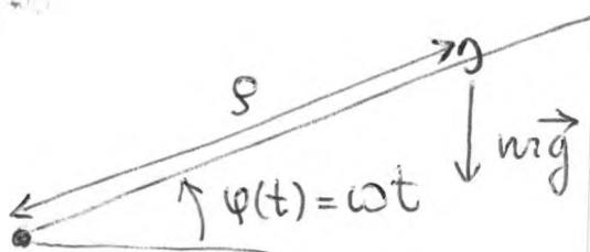
Стержень равномерно вращается:  $\varphi(t) = \omega t$ .
