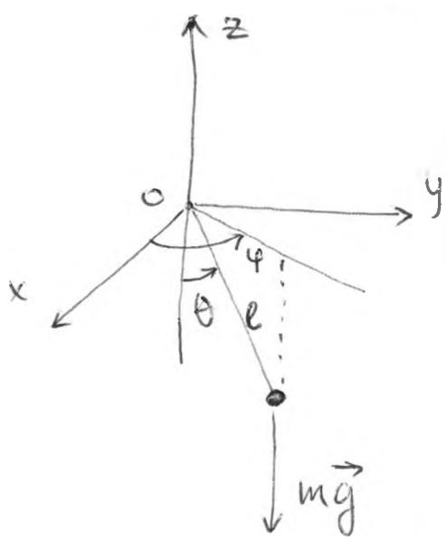
Материальная точка массой  $m$  закреплена на жесткой невесомой стержне, другой конец которого маркирован закреплен в начале координат.
