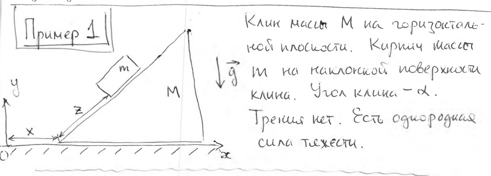
Система имеет 2 степени свободы. В качестве обобщенных координат можно выбрать  $x$  и  $z$ , (см. рис.) или заменить  $x$  на координату центра масс системы по оси  $g$ :
