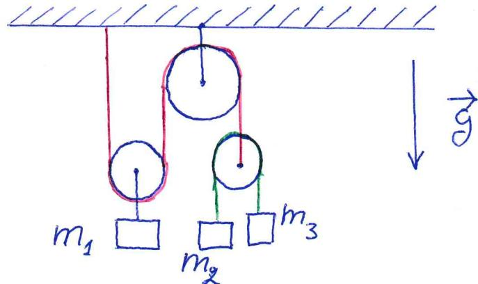
5. Грузы  $m_1$  и  $m_2$  и ось подвижного блока перемещаются только по вертикали. Правый (двойной) блок представляет собой две жестко скрепленные соосные катушки радиусов  $r$  и  $2r$ . На эти катушки наматываются или сматываются нити (отмечены зеленым и красным цветом), соединенные с грузами  $m_1$  и  $m_2$ .
