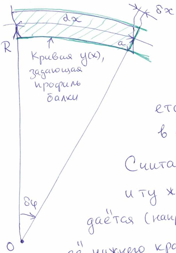
Рассмотрим небольшой отрезок балки длиной  $dx$  (см. Рис.). Под действием силы тяжести балка искривле-
