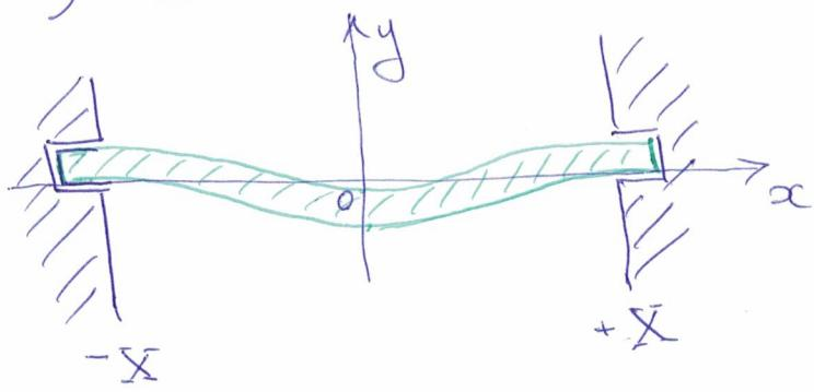
Концы балки горизонтально вблизи перекрытия в стенах.
