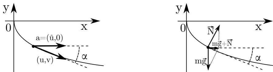
Рис. 1.8: Материальная точка равномерно спускается по кривой. На рисунке \alpha < 0 .
